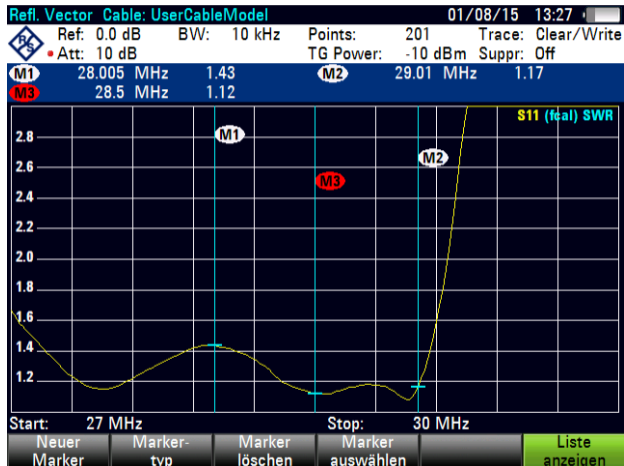
Abb. 9: Messung einer selbstgebauten Yagi für 10m bei DKØTU
